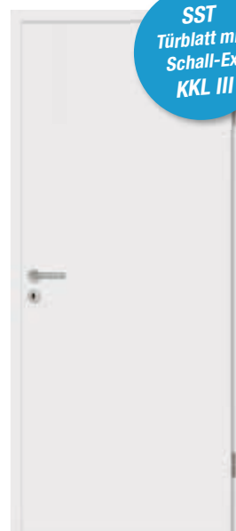
Schallschutz-Türblatt (SST) Schallschutz (SD32 = Rw, P 32 dB) Klimaklasse III inkl. Schall-Ex, Bänder V0026, PZ vorgerichtet. Bei Einsatz als Wohnungsabschlusstür ist zwingend die KKL III zu verwenden.
