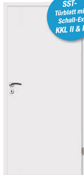
Schallschutz-Türblatt (SST) Rundkante (RP) mit Schallschutz (SD-32 = Rw, P 32 dB) Klimaklasse II oder III inkl. Schall-Ex Bänder V0026 PZ vorgerichtet. Bei Einsatz als Wohnungsabschluss- tür ist zwingend die KKL III zu verwenden.
