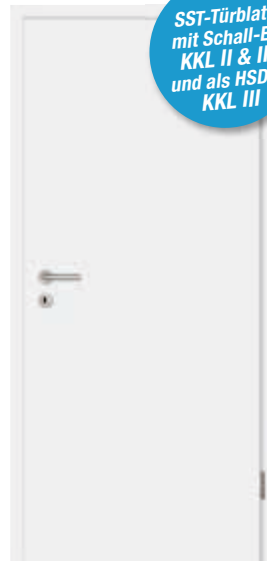
Schallschutz-Türblatt (SST) Schallschutz Klasse 1 (SD32 = Rw,P 32 dB) und Schallschutzklasse 3 (HSD43 = Rw,P 43dB) inkl. Schall-Ex, Bänder V0026WF, PZ vorgerichtet. Bei Einsatz als Wohnungsabschlusstür ist zwingend die KKL III zu verwenden.
