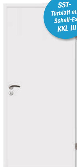
Schallschutz-Türblatt (SST) Schallschutz (SD32 = Rw, P 32 dB) Klimaklasse III inkl. Schall-Ex mit Eckkante (EC) mit Rundkante (RP) Bänder V0026, PZ vorgerichtet. Bei Einsatz als Wohnungsabschlusstür ist zwingend die KKL III zu verwenden.
